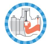
Сочетание балансирующего и запорного клапана
