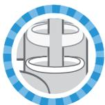
Для исключения «прикипания» штока к корпусу крана во время эксплуатации, установлено дополнительное антифрикционное кольцо PTFE.
